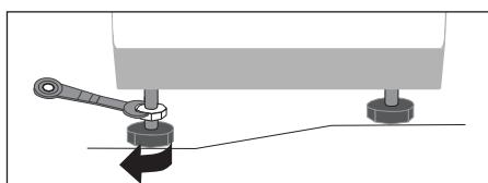
Если машина установлена на неровную или непрочную поверхность, при ее работе могут возникать шум или вибрация (допустимый угол наклона составляет всего 1°). <http://rembitteh.ru/>
